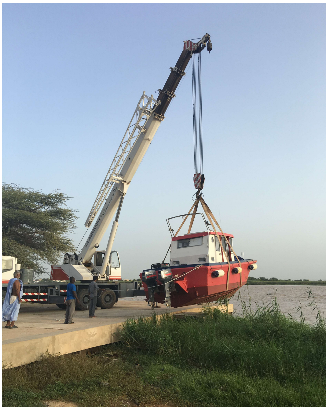
Mise à flot de la vedette hydrographique Nouatil 1 à Rosso (Rive droite du fleuve Sénégal)
